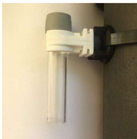
Figura 1: Dosímetre passiu NO 2 del tipus Palmes
