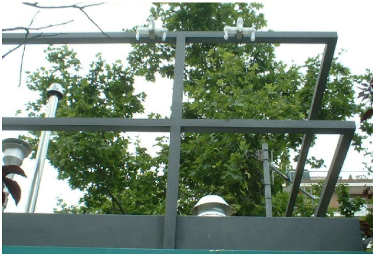
Figura 3: Col·locació del triplicat de control a l'estació automàtica
