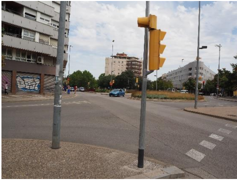
Imatge 21. Intersecció amb rotonda, carrer Santa Eulàlia amb carrer Riu Güell. Es pot observar la tangencialitat de la rotonda.
