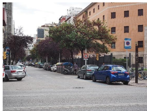
Imatge 35. C. Barcelona intersecció amb c. de Sant Joan Bta. La Salle. Pas de vianants amb manca de visibilitat per la ubicació d'aparcament de vehicles abans del pas de vianants.
