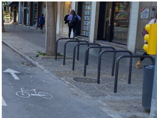
Ancoratges individuals tipus U-invertida Carrer de la Creu
