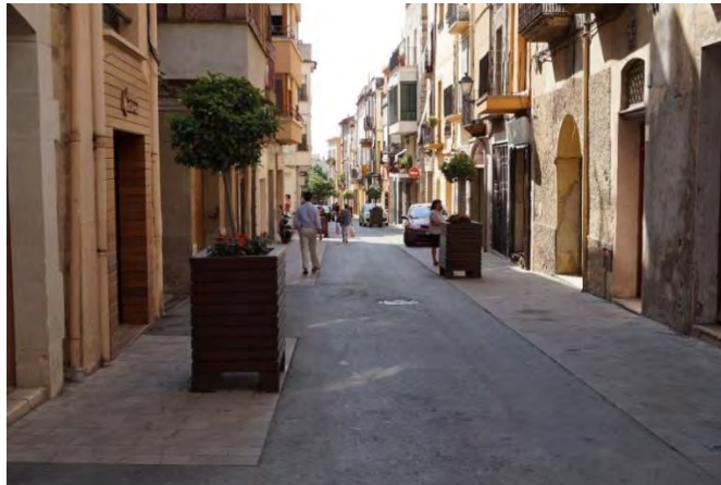
Imatge 21. Exemple de plataforma única amb obstacles al carrer Major de La Selva del Camp (Font: AIM. SL)
