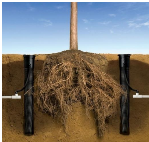
Esquema d'un Sistema de reg d'arrels RWS
