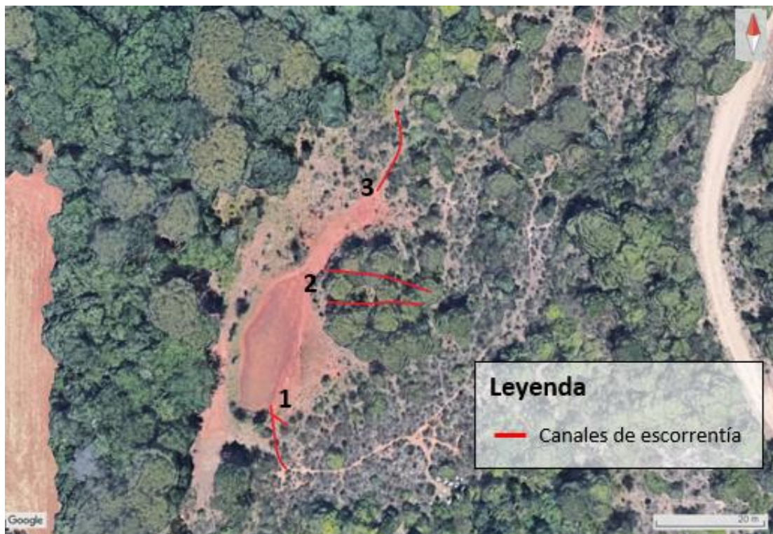
Figura 2. Esquema de las zonas de modificación y creación de canales de escorrentía.
