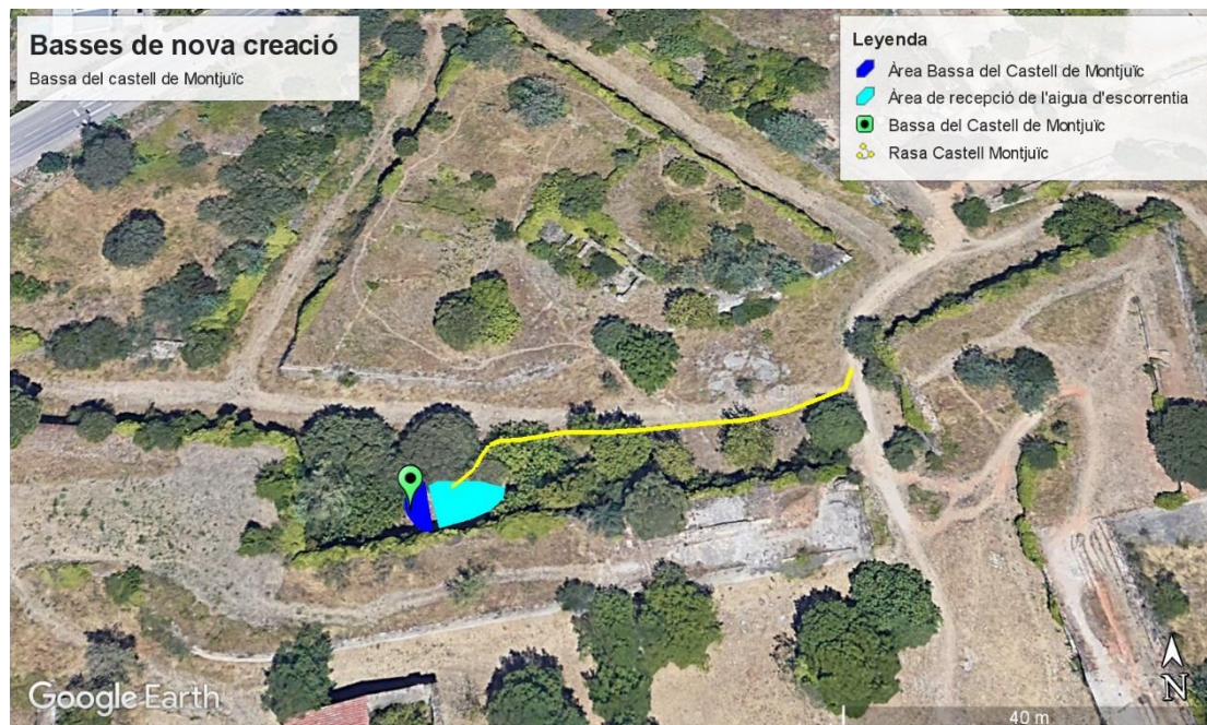
Figura 2. Esquema previsto donde se aprecia el espacio donde se acumulará el agua del nuevo hábitat acuático (azul marino y punto verde), el área de recepción del agua de escorrentía (azul cielo) y la futura rasa de canalización de agua (amarillo).
