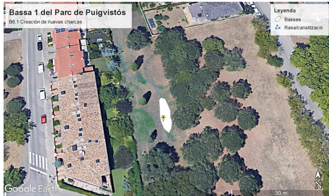
Figura 2. Esquema de la superficie prevista que tendrá la charca 1 del parc de Puigvistós (superficie blanca). Se dibuja también la dirección que tomará el agua (azul cielo) en caso de que la charca se llene al 100%.
