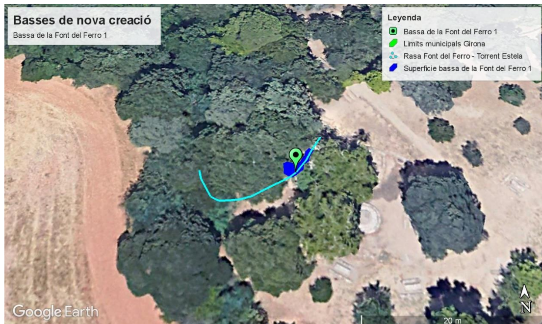
Figura 2. Esquema previsto donde se aprecia la zanja ya existente (azul cielo), y el espacio donde se excavará el nuevo hábitat acuático (azul marino y punto verde). La fuente se encuentra unos 3 metros al noreste de la futura charca, donde empieza la zanja.
